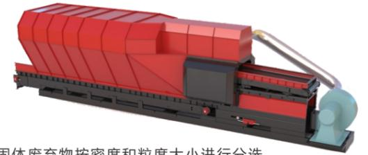
风选技术是以空气为分选媒介，利用空气动力学原理，在气流的作用下使固体废弃物按密度和粒度大小进行分选。
